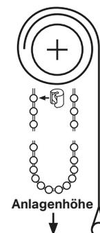
Für die obere und untere Endlage die beiliegenden Kettenstopper montieren
